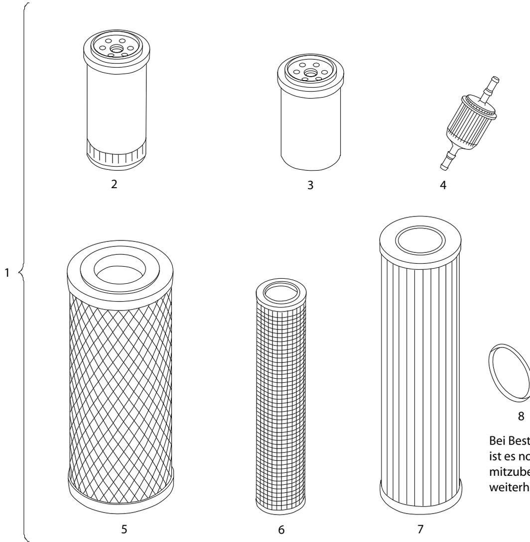
Bei Bestellung des Hydraulikoilluftfilters Pos. 7 ist es notwendig den O-Ring Pos. 8 mitzubestellen, um die Funktion des Filters weiterhin zu gewährleisten.
