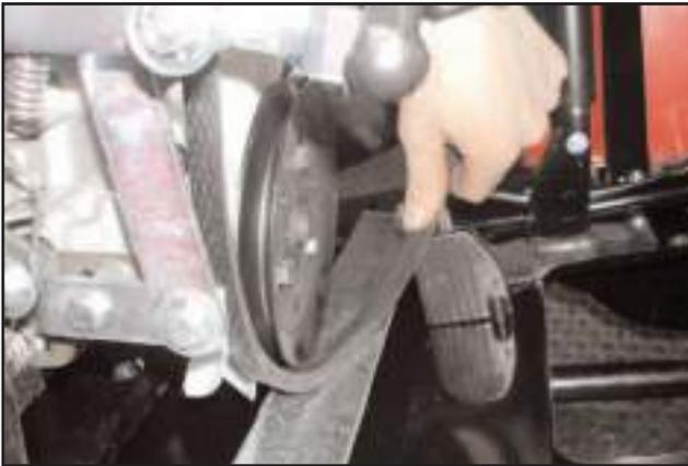
Sortir et enlever courroie trapézoïdale de la poulie à gorge pour courroie trapézoïdale (engrenages).
