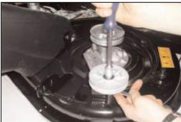
1. Dévisser écrou hexagonal (SW 13) et enlever avec rondelle plate.
