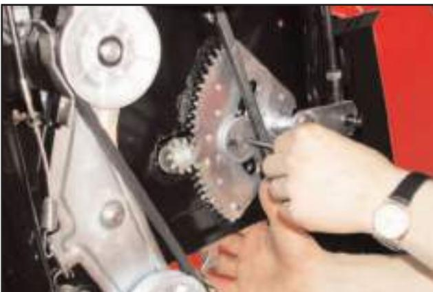
Enlever boulon à six pans creux (SW 5) avec rondelle plate, douille d'écartement et écrou (SW 13).
