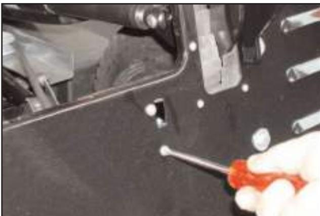
En enlevant les vis à empreinte cruciforme (2x), l'interrupteur de niveau peut être ôté.
