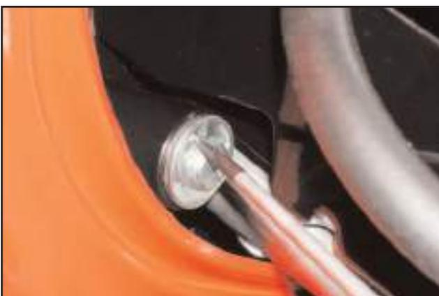
A l'arrière du segment de direction, enlever la rondelle d'arrêt avec la rondelle plate.
