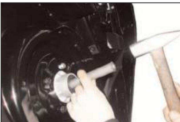
Sortir le roulement à billes /en haut (no. d'art. 700503) en tapant à partir du bas et enlever avec une douille d'écartement.
