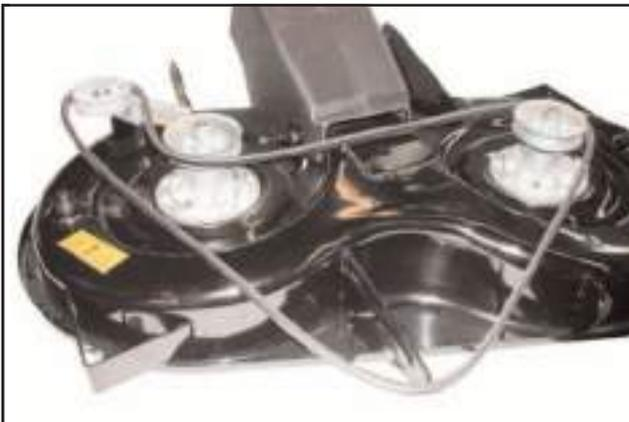
Enlever courroie trapézoïdale (no. d'art. 514877).
