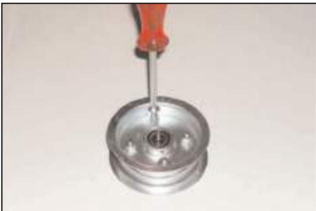
Pour échanger les paliers (no. d'art. 702256), le rouleau de tension peut être séparé en enlevant le vissage (SW 13).
